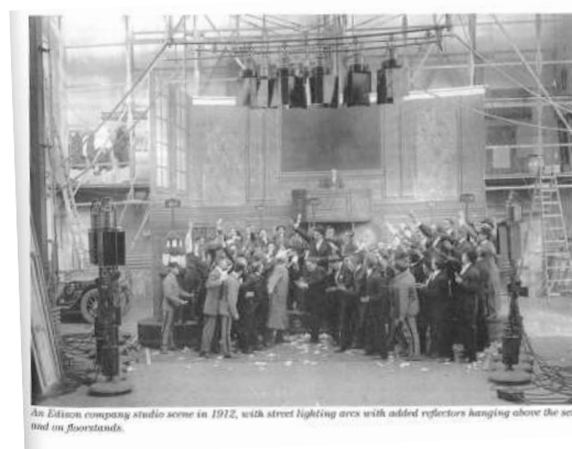
Figure 26 : Sources artificielles d'appoint, ou fill-light , dans les studios de Cinéma des années 1910.
